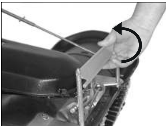
1) Verriegelung nach hinten klappen
