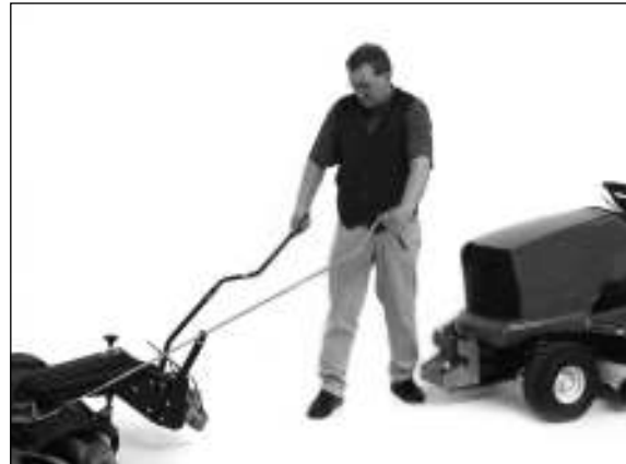
2) Kehrmaschine an den Rasentraktor heranziehen.
