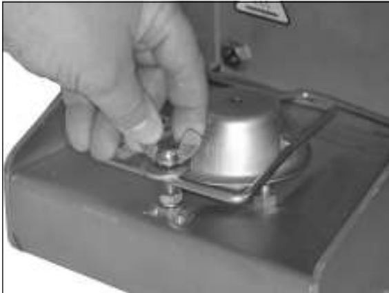
1) Flügelschraube am Schutz der Schnellwechsler lösen.
