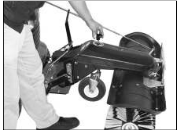
2) Das Stützrad lässt sich durch das Drehen am Ballengriff in der Höhe verstellen.
