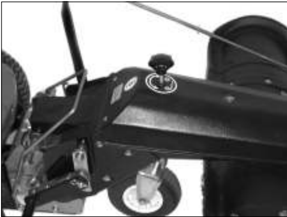
3) Optimaler Bürstendruck: Senken Sie die Bürste soweit ab, dass sie gerade eben den Boden berührt. Dann noch 3 Umdrehungen entgegen dem Uhrzeigersinn in Pfeilrichtung (-) drehen.
