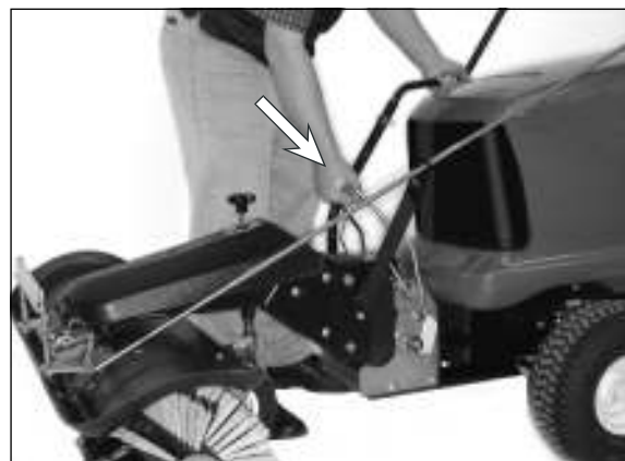
6) Kupplungsbügel schräg nach unten drücken.
