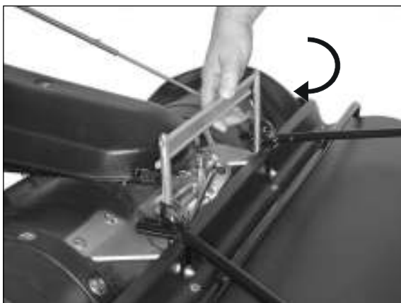
5) Verriegelung nach vorn klappen.
